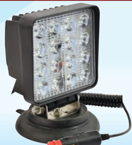
Projecteur LED 12/24V Aimanté. Cordon 2,60 m. 105 x 105 mm. Corps fonte alu. 22€90 29€90 9 LED, 27W, 1755 Lumens 16 LED, 48W, 2800 Lumens R116591 R116593
